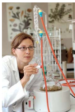
Figure 2: détermination des huiles essentielles par hydrodistillation
